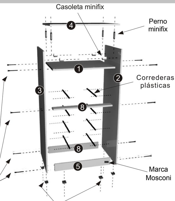
**PASO 6:** Clavar fondos a la estructura como muestra la figura
