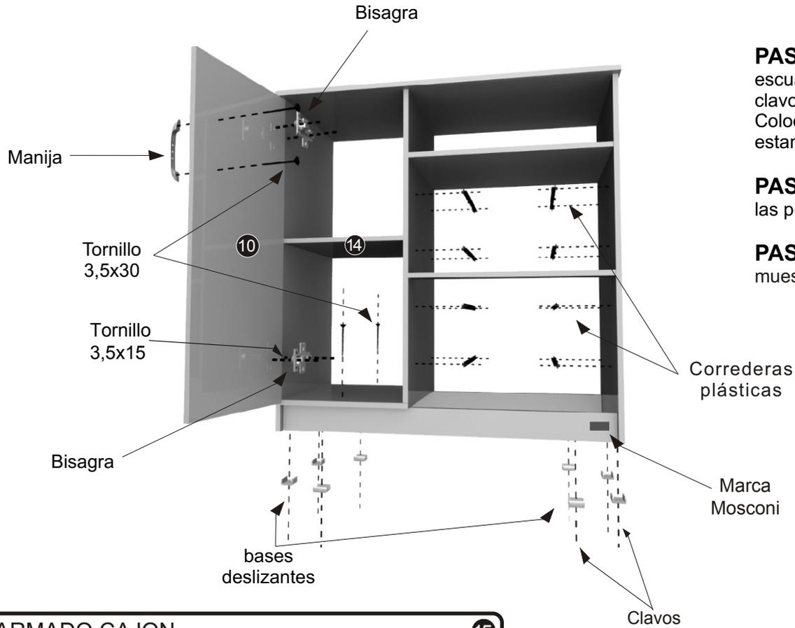
**PASO 5:** Colocar las bases antideslizantes y dar vuelta el mueble y ponerlo en escuadra, para luego colocar los fondos con su respectiva varilla H utilizando los clavos suministrados.
