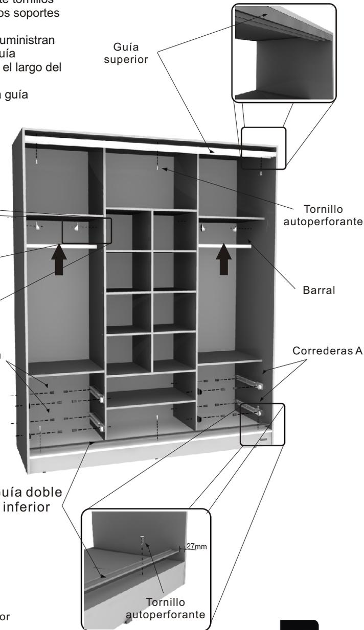
**PASO 8:** Colocar apoyos deslizantes superiores y fijarlos mediante tornillo 3,5 x 15. Luego atornillar ruedas inferiores mediante tornillo 3,5 x 15 como muestra la fig.
