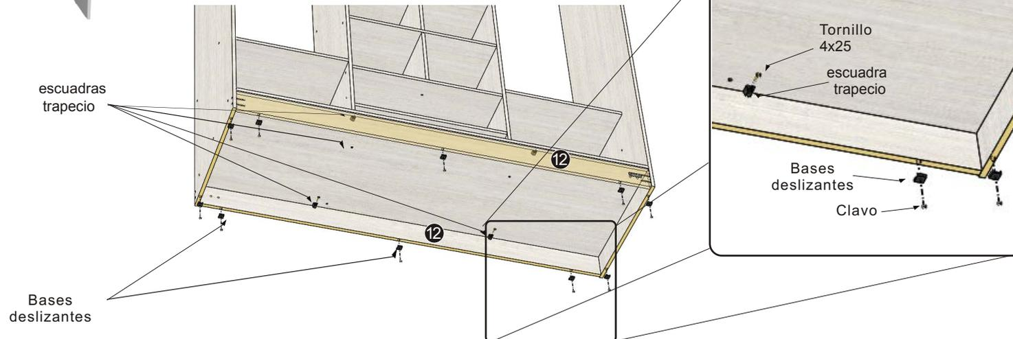
**PASO 6:** Antes de clavar los Fondos para rigidizar la estructura, chequear que la misma este escuadrada (Diagonal A y Diagonal B tengan la misma longitud) Esto es importante para la correcta alineación y funcionamiento. Por último fijar los fondos con Clavos 20mm.
